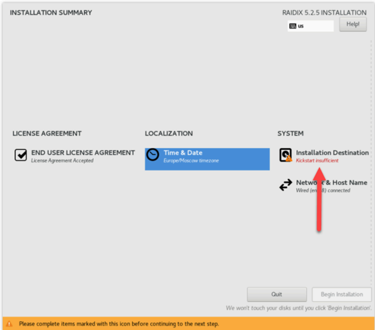
Рис. 6. Главная страница: настройка системного диска (Installation Destination)
