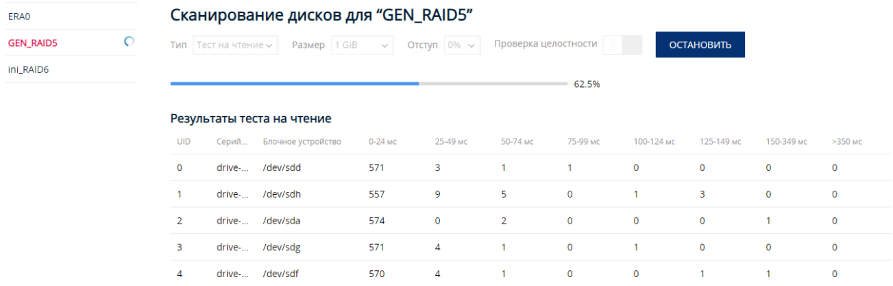
Рис. 43. Прогресс сканирование дисков. Результаты отображаются динамически
