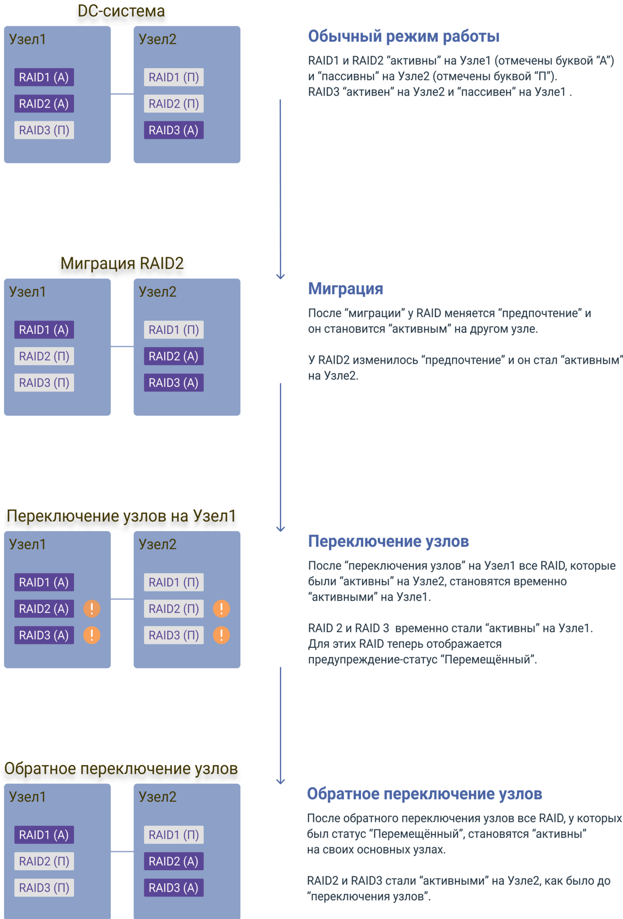
Рис. 120. Пример работы «миграции» RAID и «переключения узлов»
