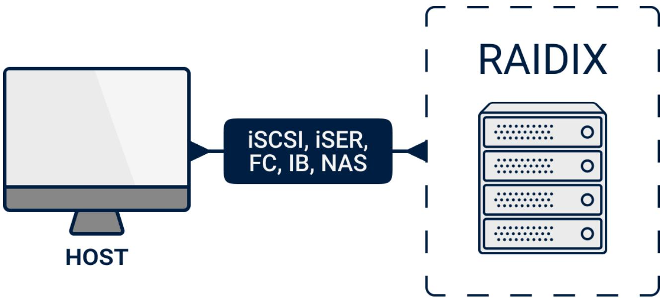
Рис. 1. ПО RAIDIX 5.2.4: Одноконтроллерный режим работы
