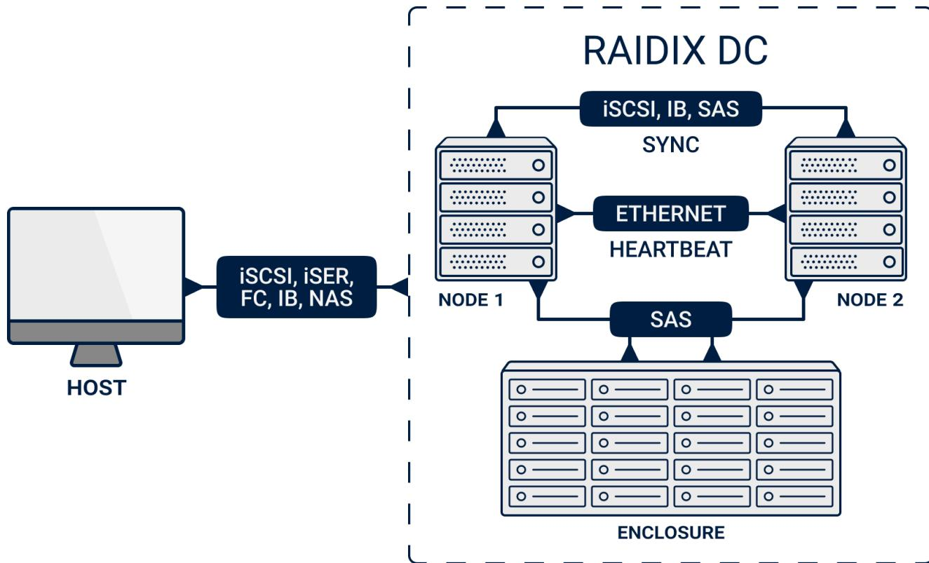
Рис. 2. ПО RAIDIX 5.2.4: Двухконтроллерный режим работы
