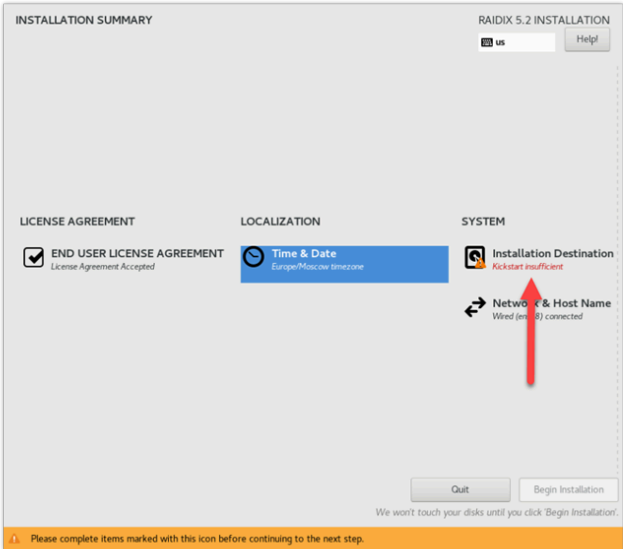
Рис. 6. Главная страница: настройка системного диска (Installation Destination)
