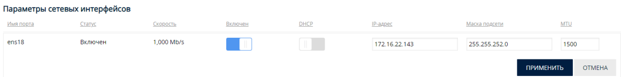
Рис. 32. Настройка сетевых параметров интерфейса для соединения по heartbeat
