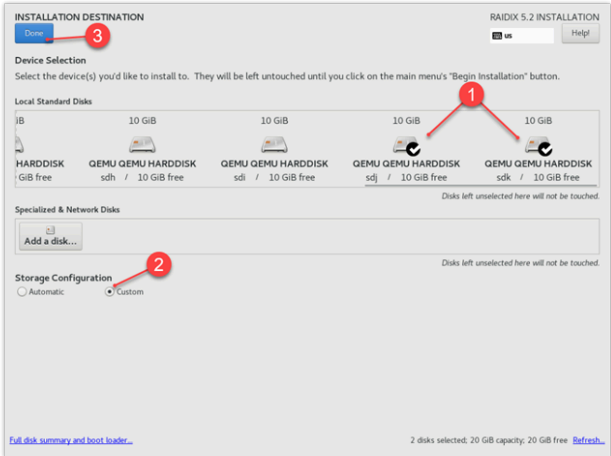
Рис. 8. Выбраны два диска для установки системы на RAID 1
