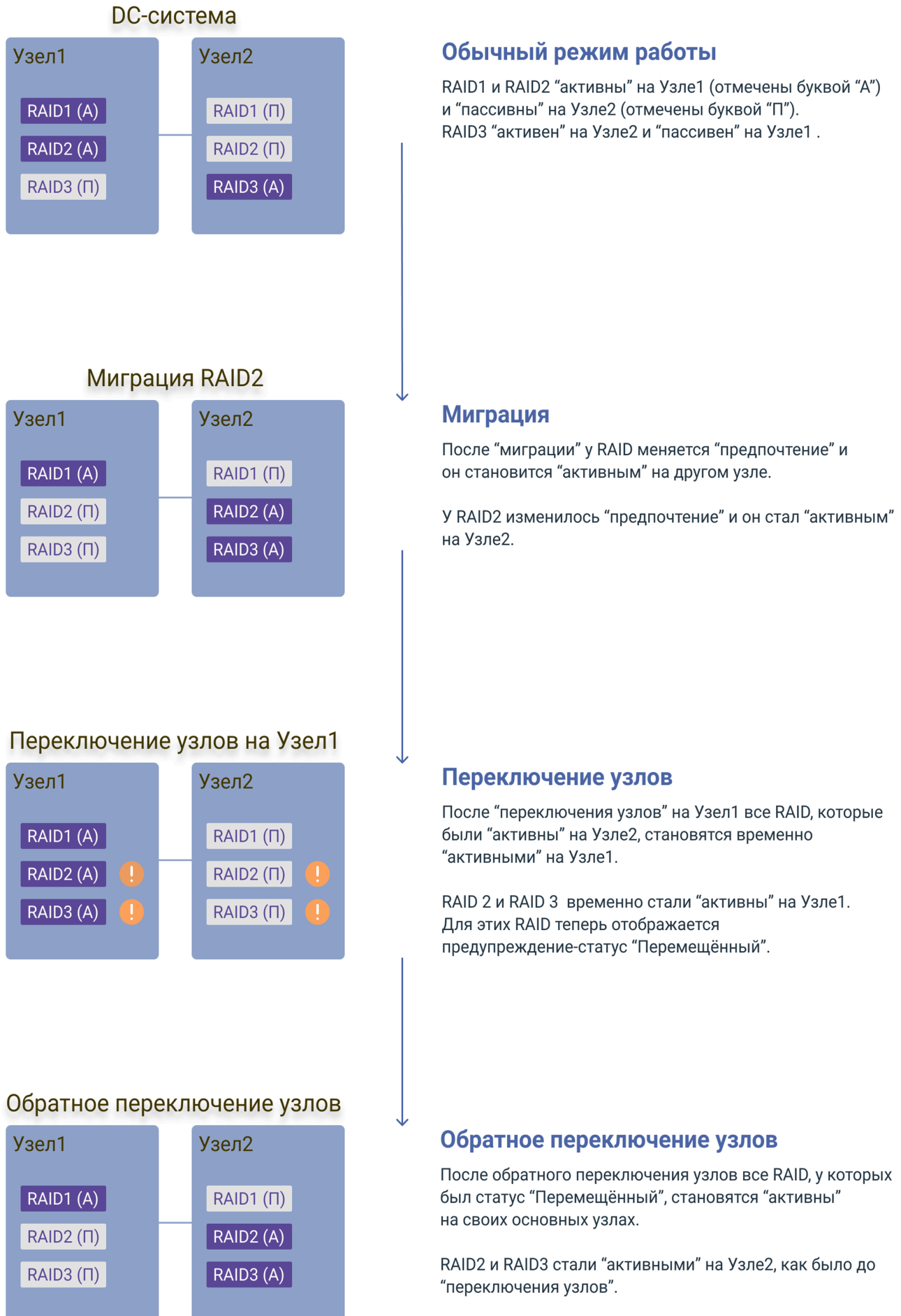
Рис. 118. Пример работы «миграции» RAID и «переключения узлов»
